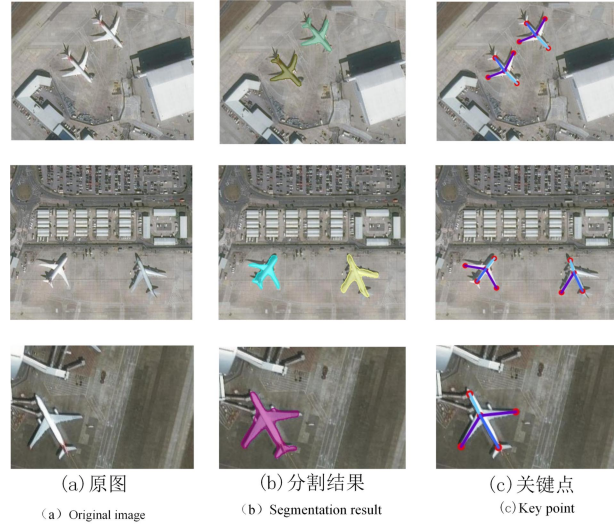
图 7.测试数据的掩膜和关键点检测结果
