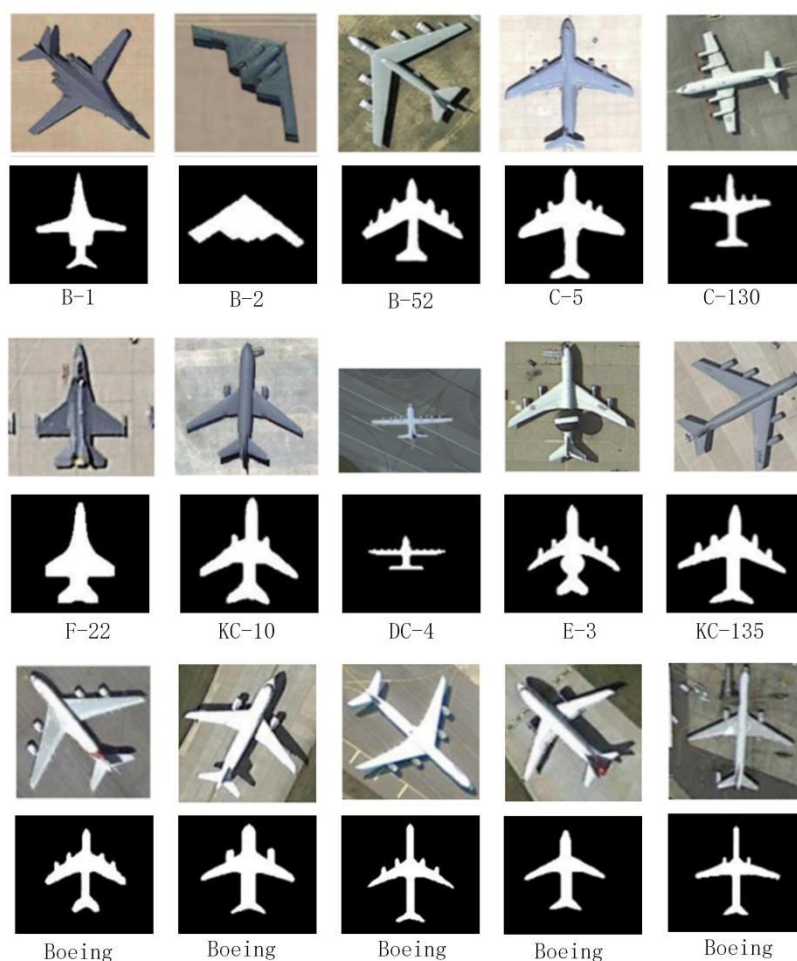
图 9. 11 种飞机的部分模板
